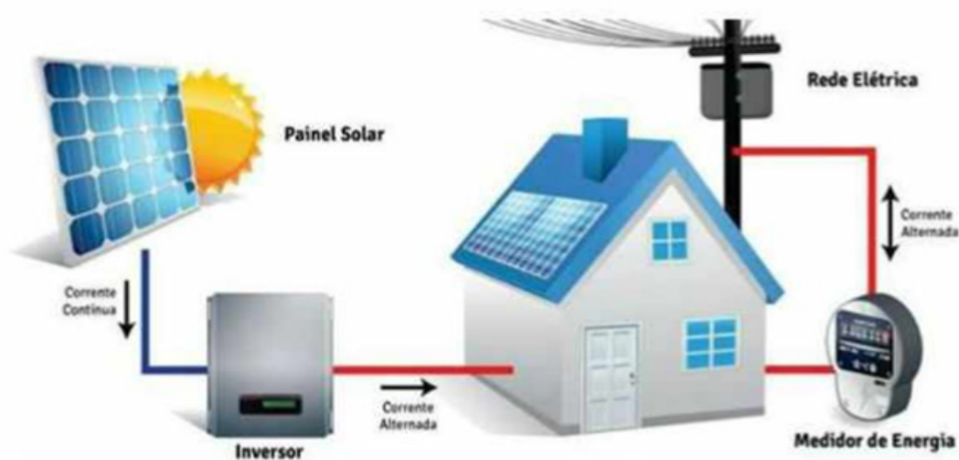
Figura 1 Funcionamento da instalação do sistema fotovoltaico na residência
