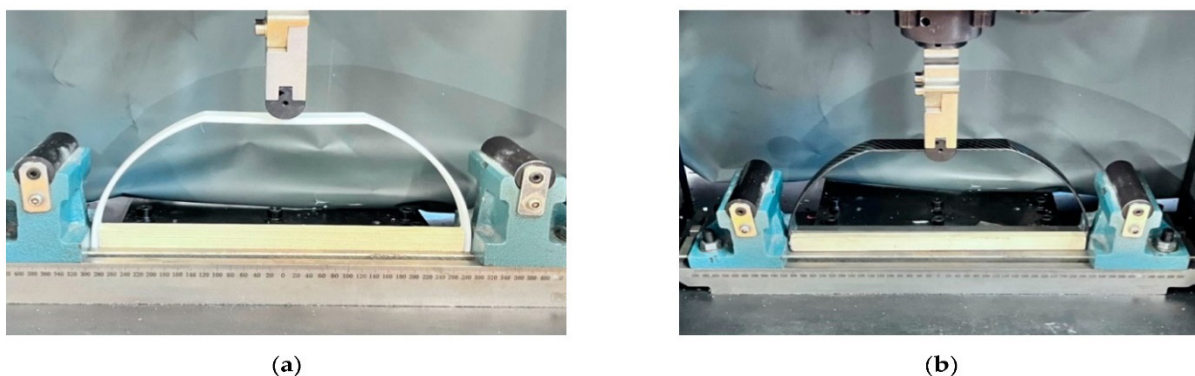
Figura 5. Ensaio de flexão em três pontos para trens de pouso feitos de: (a) PLA GF; (b) CFRP
