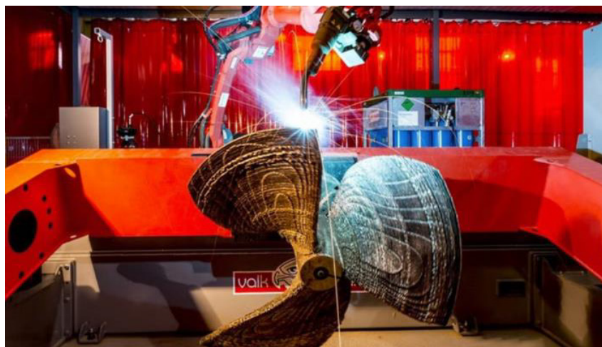
Figura 1. Fabricação de uma hélice por adição de metal em camadas através da soldagem
