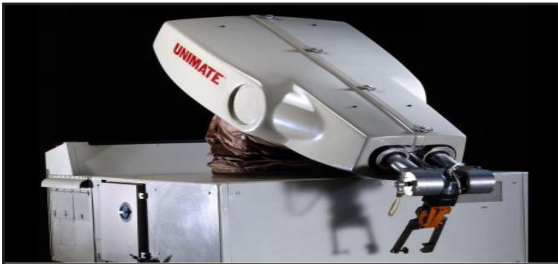
Figura 1. Robô Unimate instalado na General Motors em 1961
