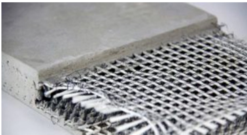
Figura 2. Concreto reforçado com fibra têxtil de carbono
