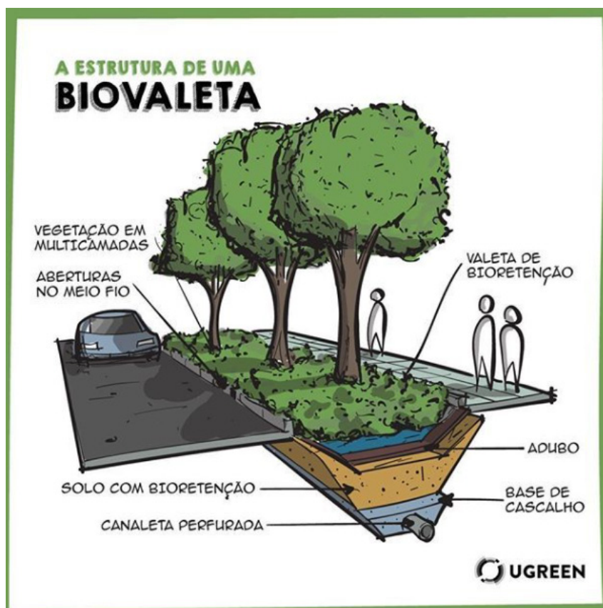
Figura 1. Estrutura de uma biovaleta
