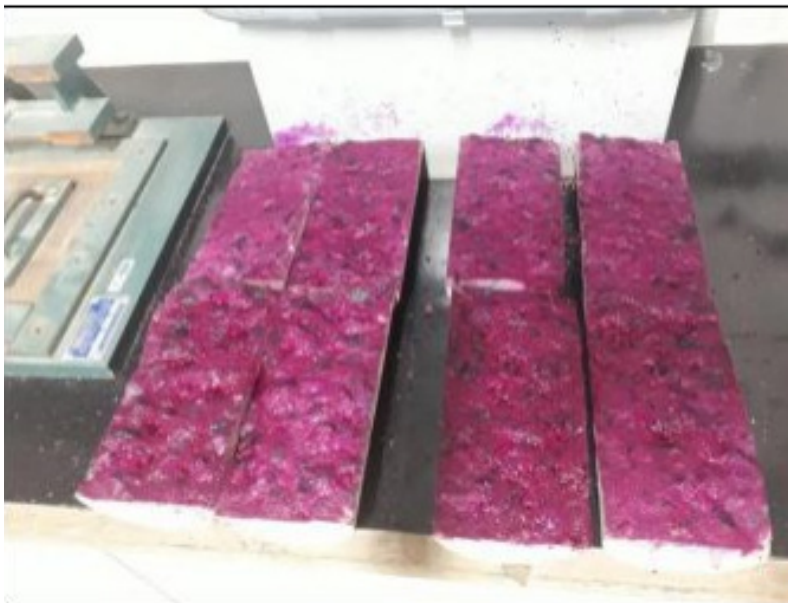
Figura 6. Estrutura de concreto em processo de carbonatação.
