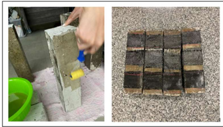
Figura 3. Aplicação da manta nos corpos de prova
