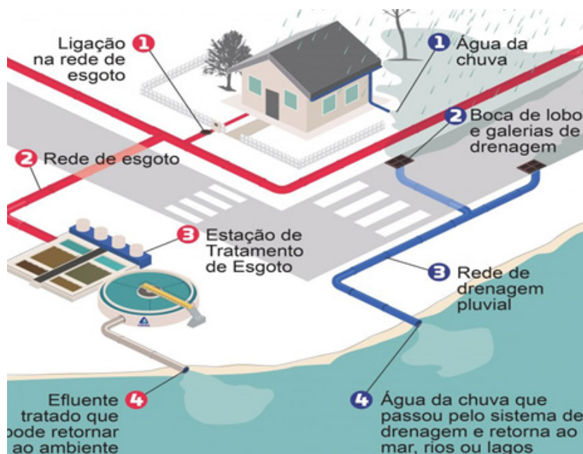
Figura 2. Rede de Esgoto e Drenagem
