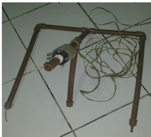
Figura 2. Lançador de Foguetes construído de canos PVC
