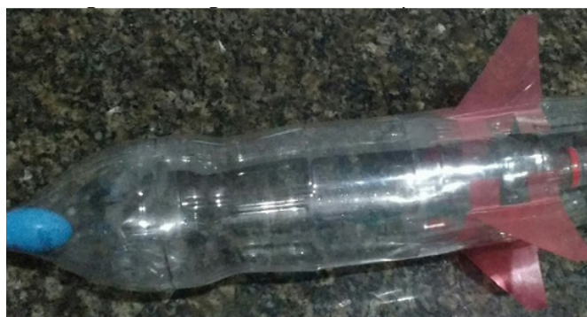
Figura 3. Foguete artesanal construído com garrafas Pet
